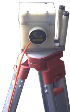
图 5.7-1 深度记录装置安装
