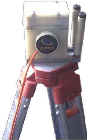
图 4.1.1 深度记录装置安装
