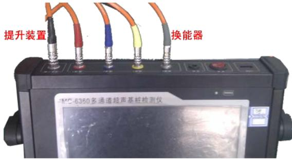
图 4.1.5 深度记录装置连接
